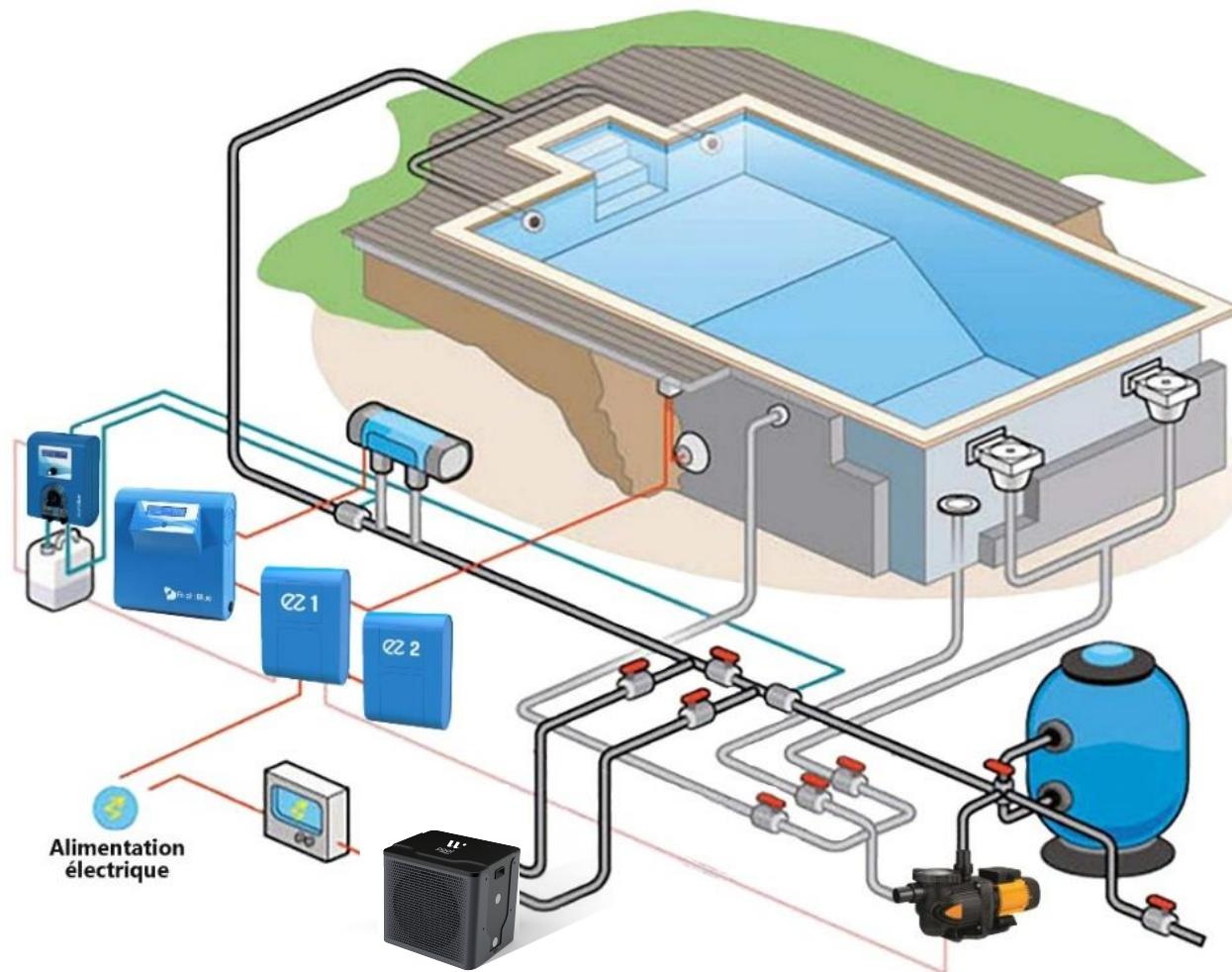
**FR :** Votre pompe à chaleur doit être placée à l'extérieur et doit respecter les distances minimales de 50cm sans obstacles sur les côtés - 50 cm du mur pour l'arrière et 15cm au-dessus du sol.
